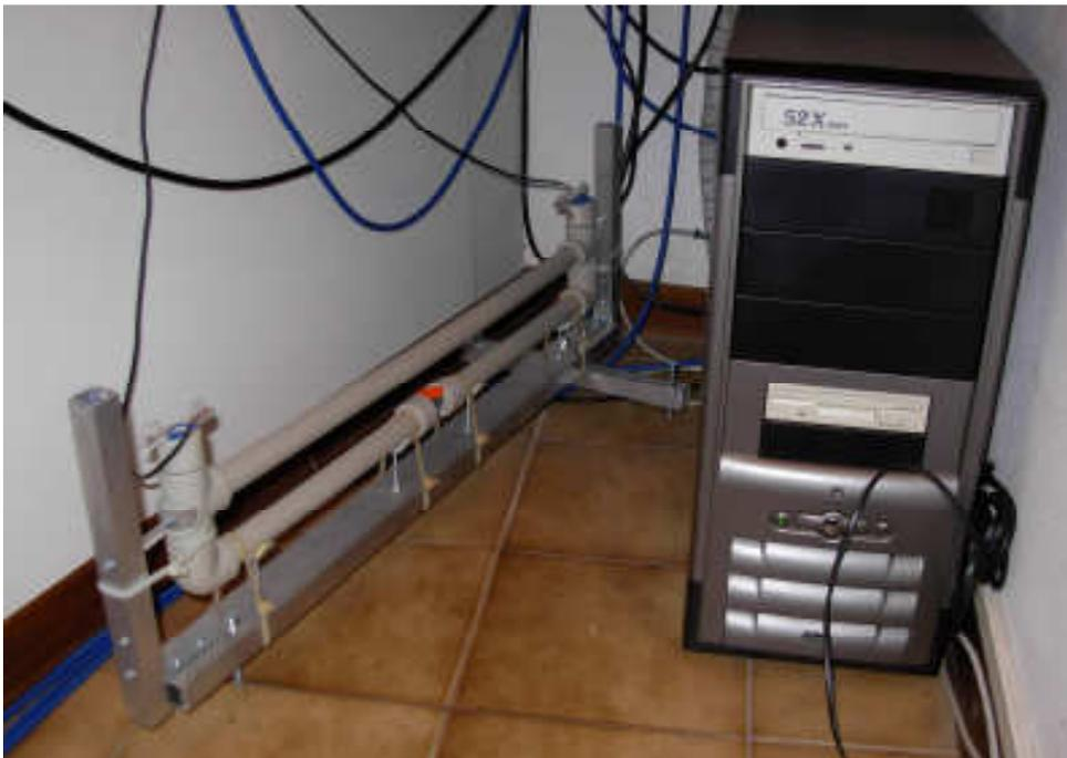
**Figura 9** – Prototipo sensore a massa fluida FMES.
