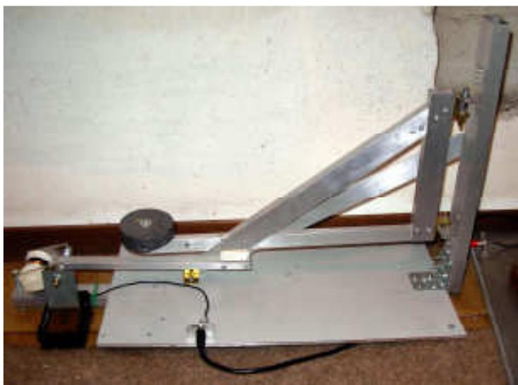
**Figura 7** – Esempio di semplice sensore tipo Lehman autocostruito
